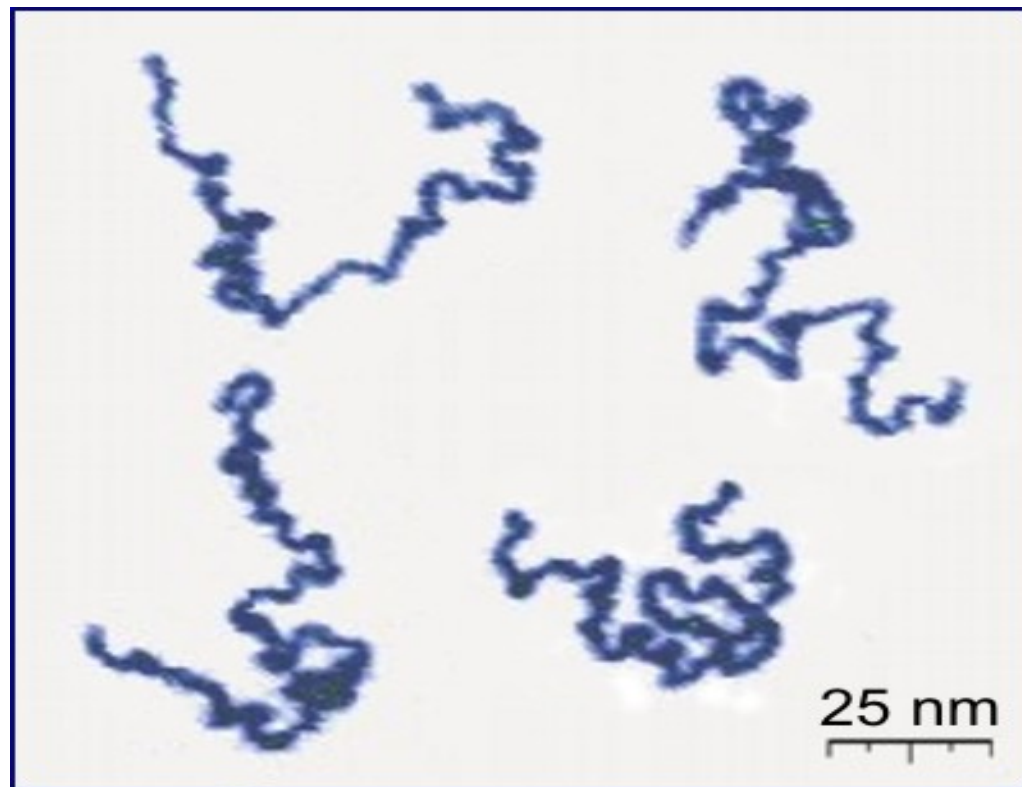
Atomic-Force mikroskop billed af polymere på en overflade. Bredde ~ 0.4nm, længde 204nm (Kilde: Wikipedia)
